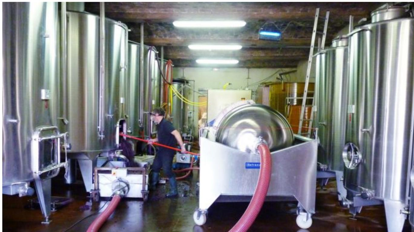
Ici, l'étape du pressurage : une fois la fermentation alcoolique achevée, le marc est envoyé dans le pressoir, pour ne conserver que le jus et écarter les pépins et les pellicules.
